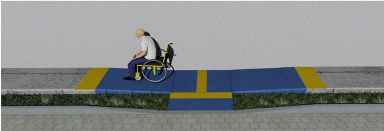
Persp. ilustrativa – Rampa estreita com canteiros
